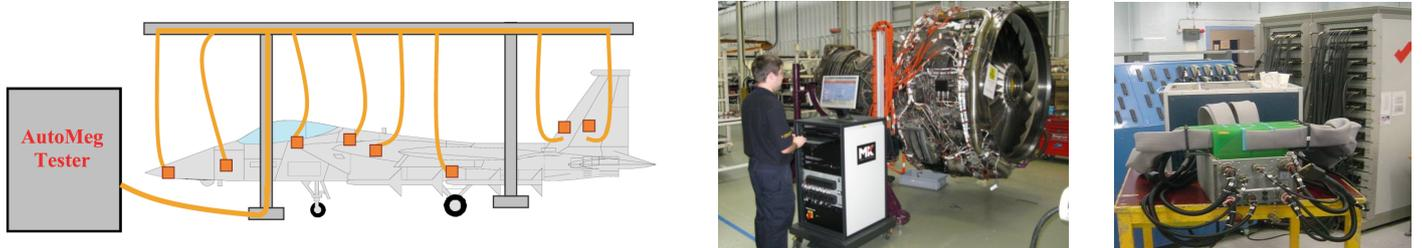
整机电缆网转接方式
